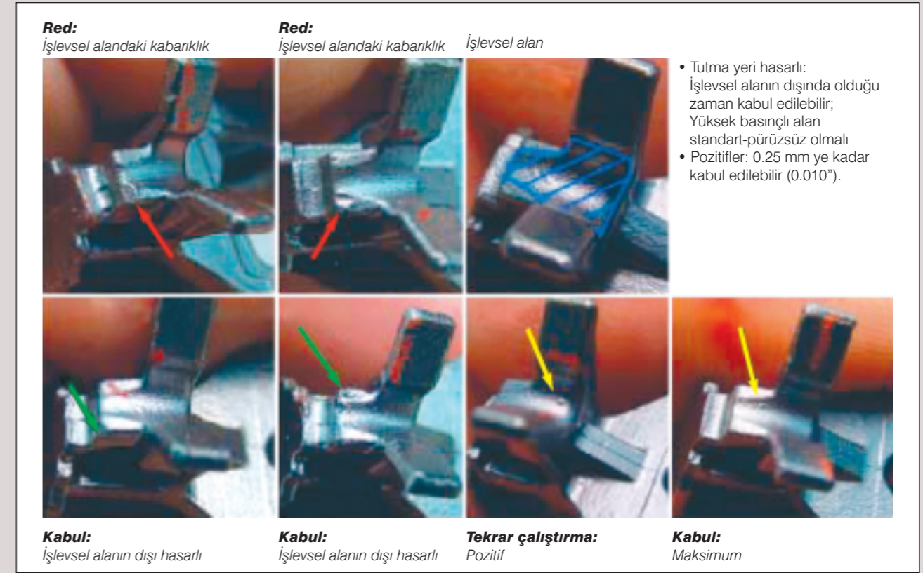
Şekil-3: Tutma/Kavrama bölgesindeki hasarlar ve pozitif olanlar
